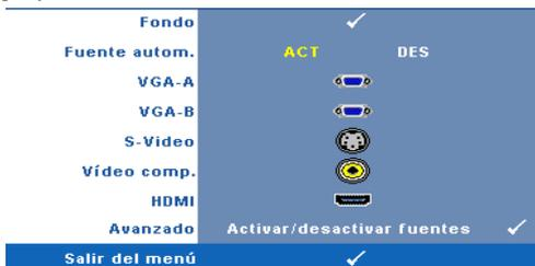
**FUENTE AUTOM.**—Seleccione **Des** (valor predeterminado) para bloquear la señal de entrada actual. Si presiona el botón **Fuente** mientras el modo **Fuente autom.** está establecido en **Des**, podrá seleccionar manualmente la señal de entrada. Seleccione **Act** para detectar
